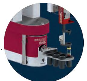
Für die Methode ISO 18363-4:2021 (Zwagerman - Overman) bietet GERSTEL AppNote 239 einen detaillierten Überblick über die Leistung des automatisierten Analyzesystems. Zwei interne Standards kompensieren selbst geringfügige Abweichungen in chemischen Reaktionen und in der Probenvorbereitung. Einige Systemdetails:
