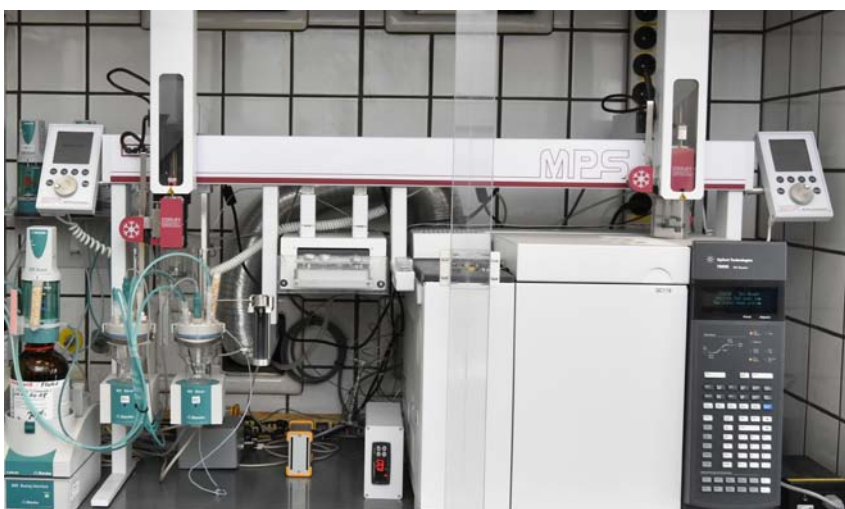
Rund zwei Jahre hat die Entwicklung dieses bei INEOS in Köln installierten GERSTEL-Analysensystems von der Idee bis zur Realisierung in Anspruch genommen. Zentrale Elemente sind die integrierten Titratoren (Metrohm) zur Bestimmung von Säure- und Wassergehalt sowie die gekühlten Spritzen (GERSTEL-CoolSy).
