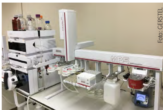
MPS-robotic pro mit DPX-Option und m VAP in Kombination mit einem HPLC-QQQ-MS-System, verwendet für die Bestimmung unterschiedlicher Opiode in Urin.
