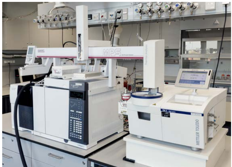
Von der BAM für die analytische Bestimmung thermoplastischer und elastomerer Mikroplastikpartikel verwendetes TED-GC/MS-System. (Foto: BAM)
